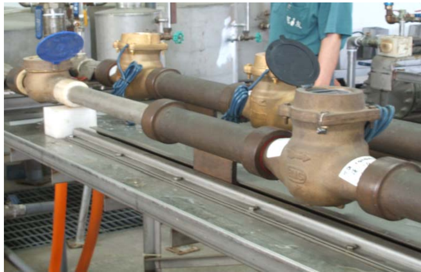
圖 3.1 (弓銓流量實驗室 TD50mm 與 YT40mm 串聯實測照片)
