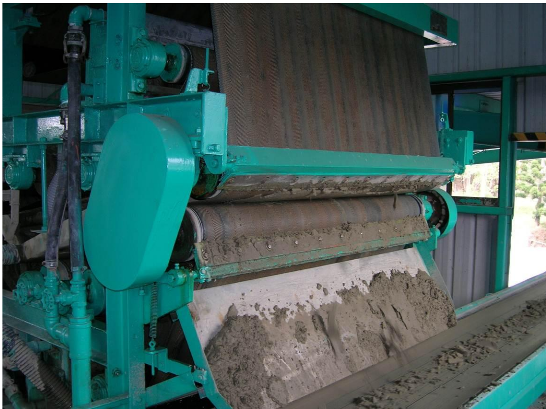
圖示 7：污泥脫水機操作現況
